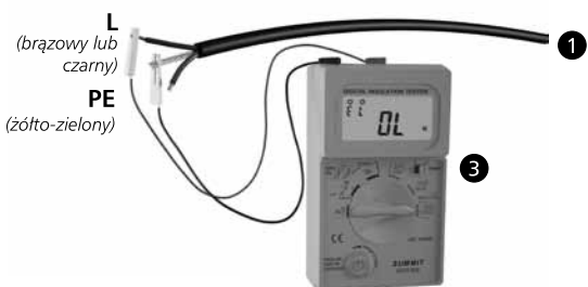
Pomiar rezystancji izolacji
